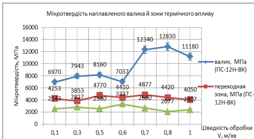
Рис.13. Вплив швидкості лазерного випромінювання на мікротвердість ПС-12Н-ВК. Умови експерименту:  $\lambda = 1,06$  мкм,  $P = 1000$  Вт,  $d\varnothing = 3$  мм
