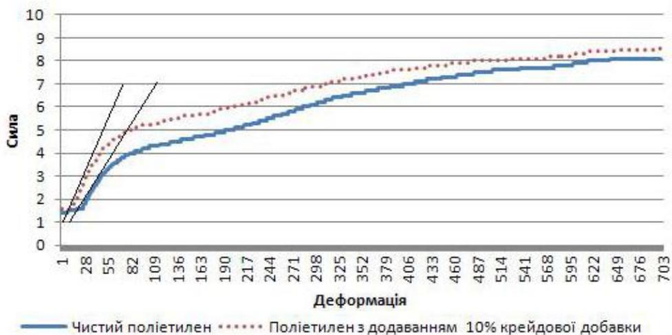
Рис. 2. Діаграма розтягу поліетиленових плівок
