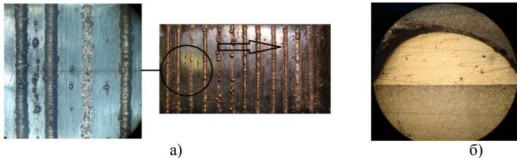
Рис. 8. Загальний вигляд дослідного зразку композиту Бр010. Режими спікання:  $P=300$  Вт,  $v = 0,1 - 0,5$  м/хв.,  $d_{\text{п}} = 3$  мм. Обробка по стрілці. Збільшення –  $\times 32$ . Шліфи композиту Бр010: а –  $v = 0,2$  м/хв.;  $d_{\text{п}} = 3$  мм;  $P = 300$  Вт; б –  $v = 0,1$  м/хв.;  $d_{\text{п}} = 3$  мм;  $P = 500$  Вт. Витрати аргону 7 л/хв. Збільшення -  $\times 100$
