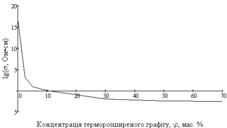
Рис. 2. Залежність логарифму об'ємного електричного опору від концентрації ТРГ.
