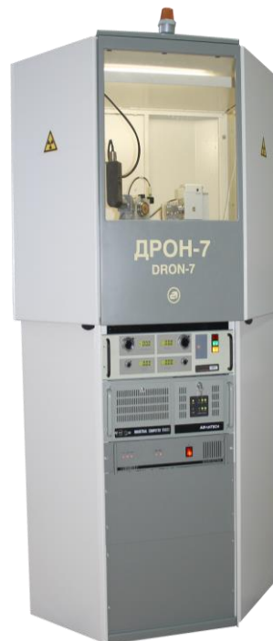
Рис. 2.7. Рентгенівський дифрактометр ДРОН-7
