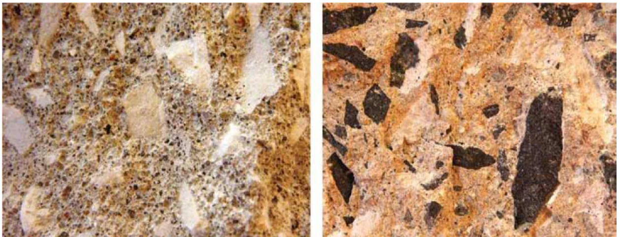
Рис. 4.11. Електронномікроскопічний аналіз структури бетону з різновидами наповнювача (Бикбау М.Я., 2013)
