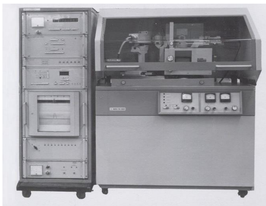
Рис. 2.5. Рентгенівський дифрактометр ДРОН-3М.
