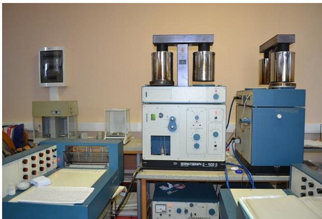
Рис. 1.3. Поліцільовий вимірювальний прилад «Derivatograph Q-1000»
