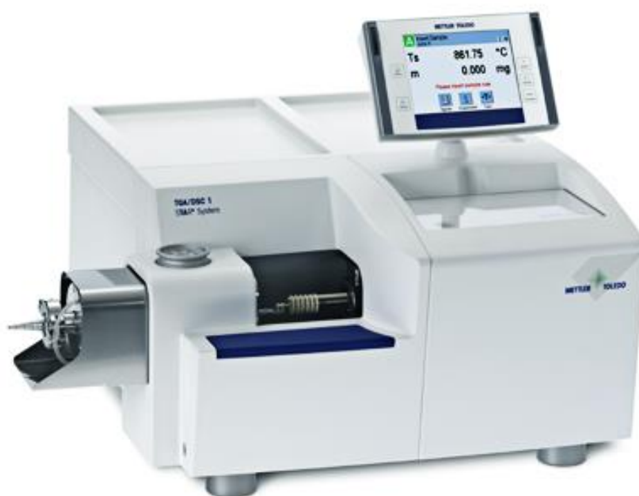
Рис. 1.5. Дериватограф типу TGA/DSC1
