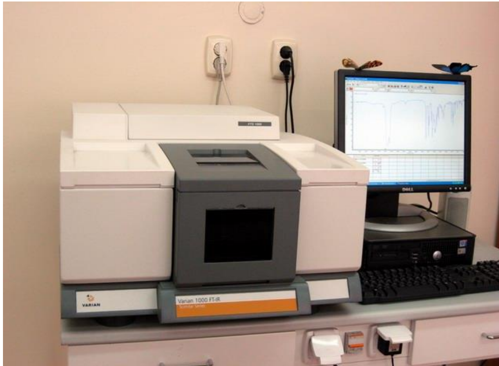
Рис. 5.6. ІЧ Фур'є спектрометр типу Scimitar 1000 з персональним комп'ютером
