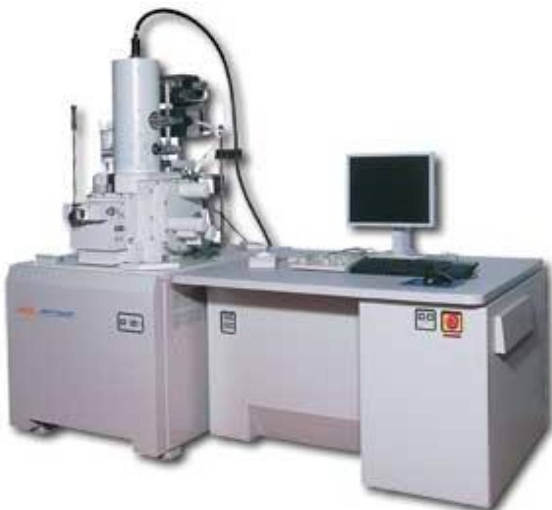
Рис. 4.3. Скануючий (растровий) електронний мікроскоп JEOL JSM-7600F.
