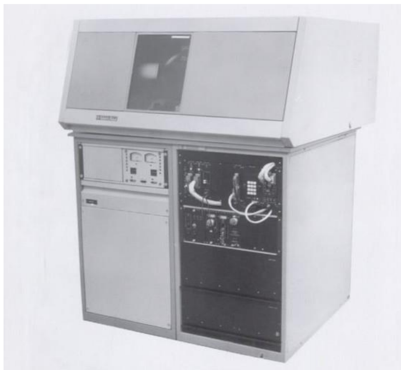
Рис. 2.4. Рентгенівський дифрактометр ДРОН-3.
