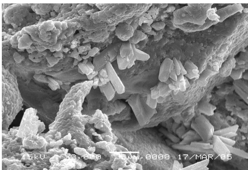
Рис. 4.8. Мікроструктура доменного шлаку після швидкісного випалу на 1040 °С (x 3000).
