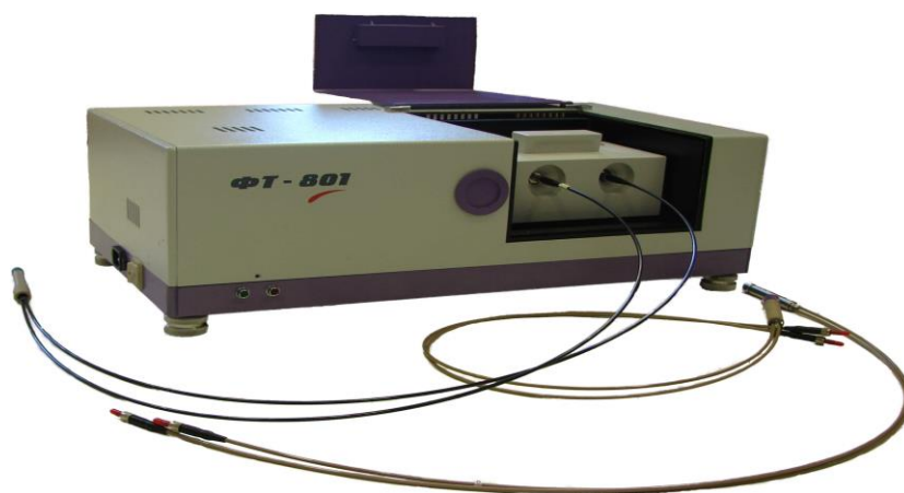
Рис. 5.4. ІЧ Фур'є - спектрометр типу ФТ-801
