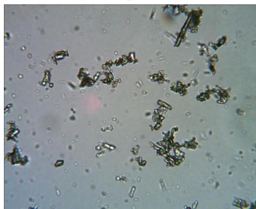
Рис. 1. Частицы волластонита (увеличение в 600 раз): а - №1; б - №2
