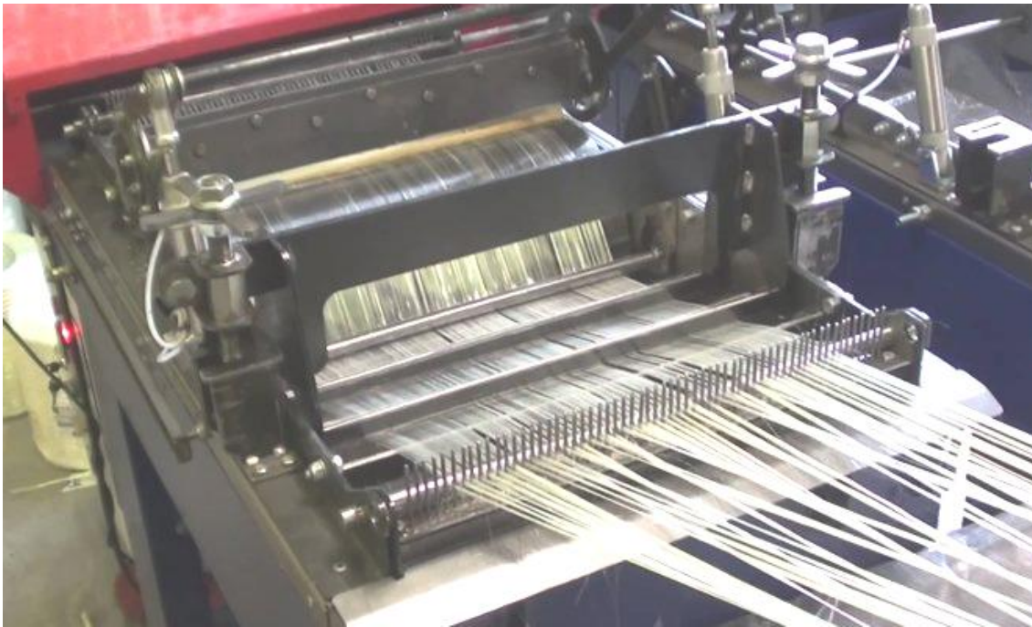
Рис. 6.2. Пристрій для підігрівання і розділення ниток скловолокна
