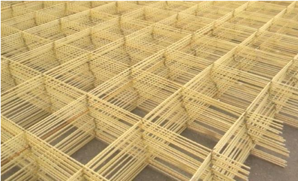
Рис. 6.1. Арматурна склопластикова сітка 100x100 мм для виготовлення будівельного композиту
