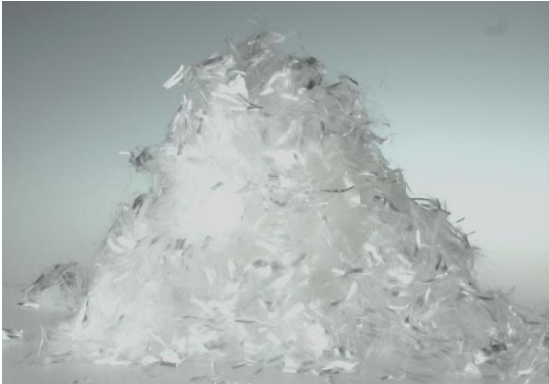
Рис. 5.1. Поліпропіленове волокно для армування будівельних композитів
