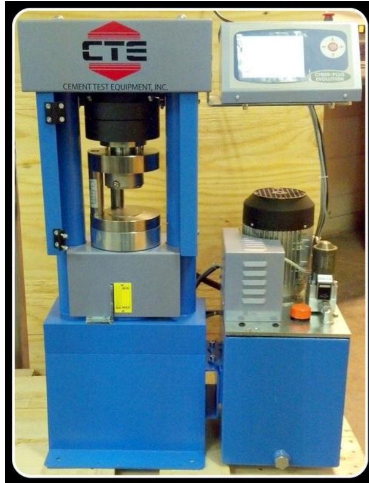
Рис. 4.1. Гідравлічний прес STE 5000 для тестування міцності на стиск
