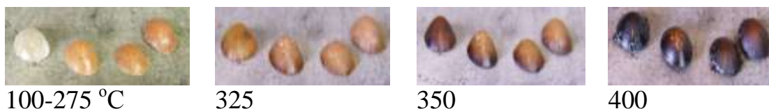
Рис.3. Вид образцов при разных температурах (100 – 400 °С). Слева направо на каждой из фото – образцы с 0, 10, 25 и 50 мас% пирофиллита
