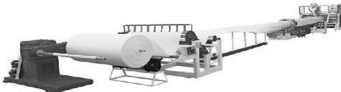
Рис.1. Линия по производству вспененного ПЭВД
