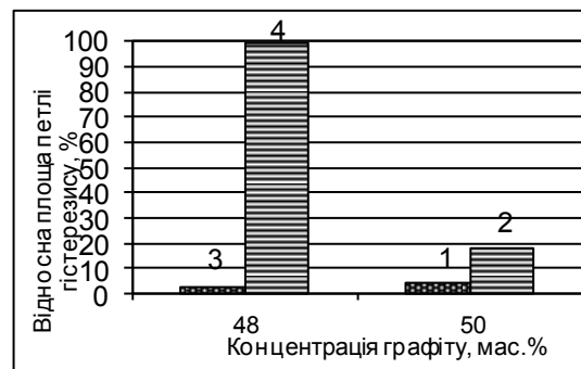
Рис. 4. Вплив виду суміщення на процеси структуроутворення в системах: ПМФС+С-1 (1, 2) та ПМФС + С-1 + ТРГ (2 мас.%) (3, 4)
