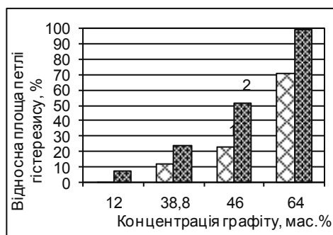
Рис. 1. Вплив концентрації графіту марки ГЛС-1 на структуроутворення в системах: ПМФС + графіт (1) і ПМФС+графіт+1мас.% аеросилу (2)
